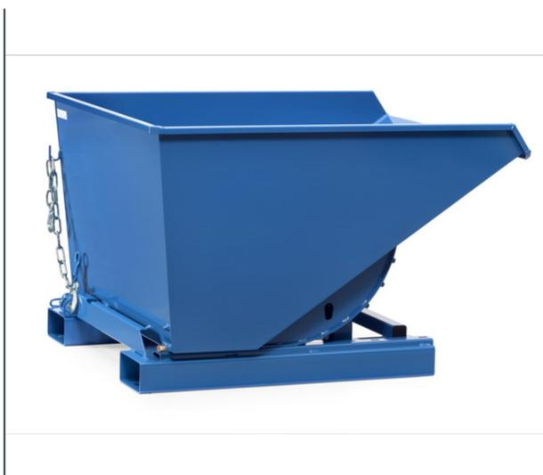
Construction robuste en tôle d'acier de 3 mm mécano-soudée et étanche. Revêtement époxy bleu RAL 5007. De serie avec passage de fourches. Versement sans risque de basculement, verrouillage anti-ouverture et chaîne de sécurité. Système d'ouverture par câble ramené au siège du conducteur. Livrée avec câble. Roues en option.
