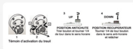
MISE EN SERVICE DU TREUIL DE SAUVETAGE
